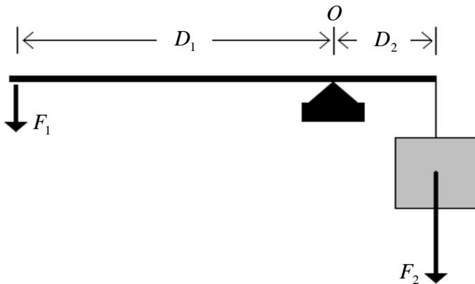
*Figura 2. Una peso de magnitud  $F_2$  es equilibrado mediante una fuerza inferior de magnitud  $F_1$ .*
