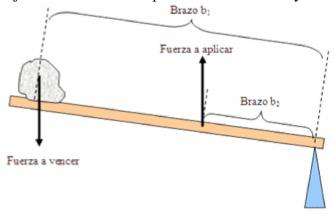
Este tipo de palanca parece difícil de encontrar como ejemplo concreto, sin embargo... el brazo es un buen tipo de este caso, y cualquier articulación es de este tipo, también otro ejemplo lo tenemos al levantar una cuchara con sopa o el tenedor con los tallarines, una pinza, una corchetera también es un ejemplo de este tipo.
