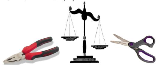
Algo que desde ya iremos destacando es que al accionar la palanca se producirá un movimiento rotatorio respecto al fulcro que en ese caso sería el eje de rotación.
