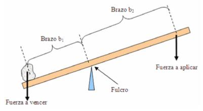
Con este tipo de palancas pueden moverse grandes pesos, basta que el brazo  $b_1$  sea más pequeño que el brazo  $b_2$ . Algunos ejemplos de este tipo de palanca son: el balancín, la balanza, el remo, el atornillador, la tijera y el alicate.
